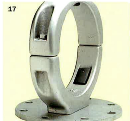
Die Lagerung ist elektrisch so isoliert, daß im Kurzschlußfall ein Nebenschluß vermieden wird. Ein Ladungsausgleich (Potentialausgleich) zwischen Rohrleiter und Stützer ist vorhanden.
