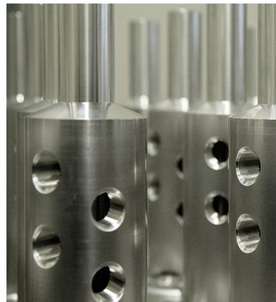
Was einfach klingt, stellt hohe Anforderungen an die Fertigungstechnik. Neben der Tatsache, dass tausende Ampere Strom auf die Metallteile treffen, sind die verschiedenen Werkstoffe, die im Bereich der Energieverteilung eingesetzt werden, eine Herausforderung. «Meistens lassen wir die Komponenten versilbern oder verzinnen, um Korrosionsschäden zu vermeiden», erklärt Sefag-Produktmanager Daniel Bieri.
